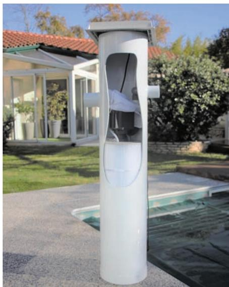
Module de filtration éco-responsable à positionner dans le remblai de la piscine pendant sa construction. Adaptable à toutes les dimensions de bassins, ce module avec un traitement automatique par électrolyse de l'eau intégré, permet de réduire les consommations d'électricité et d'eau de 80 %. La fréquence d'entretien est espacée grâce à des filtres à cartouche surdimensionnés.
